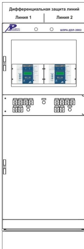
Шкаф дифференциальной защиты линий (для схемы РУ с двумя выключателями на присоединение или с двойной системой шин с обходной) ШЭРА-ДЗЛ-2002 БПВА.656457.233, БПВА.650645.001 ТУ
